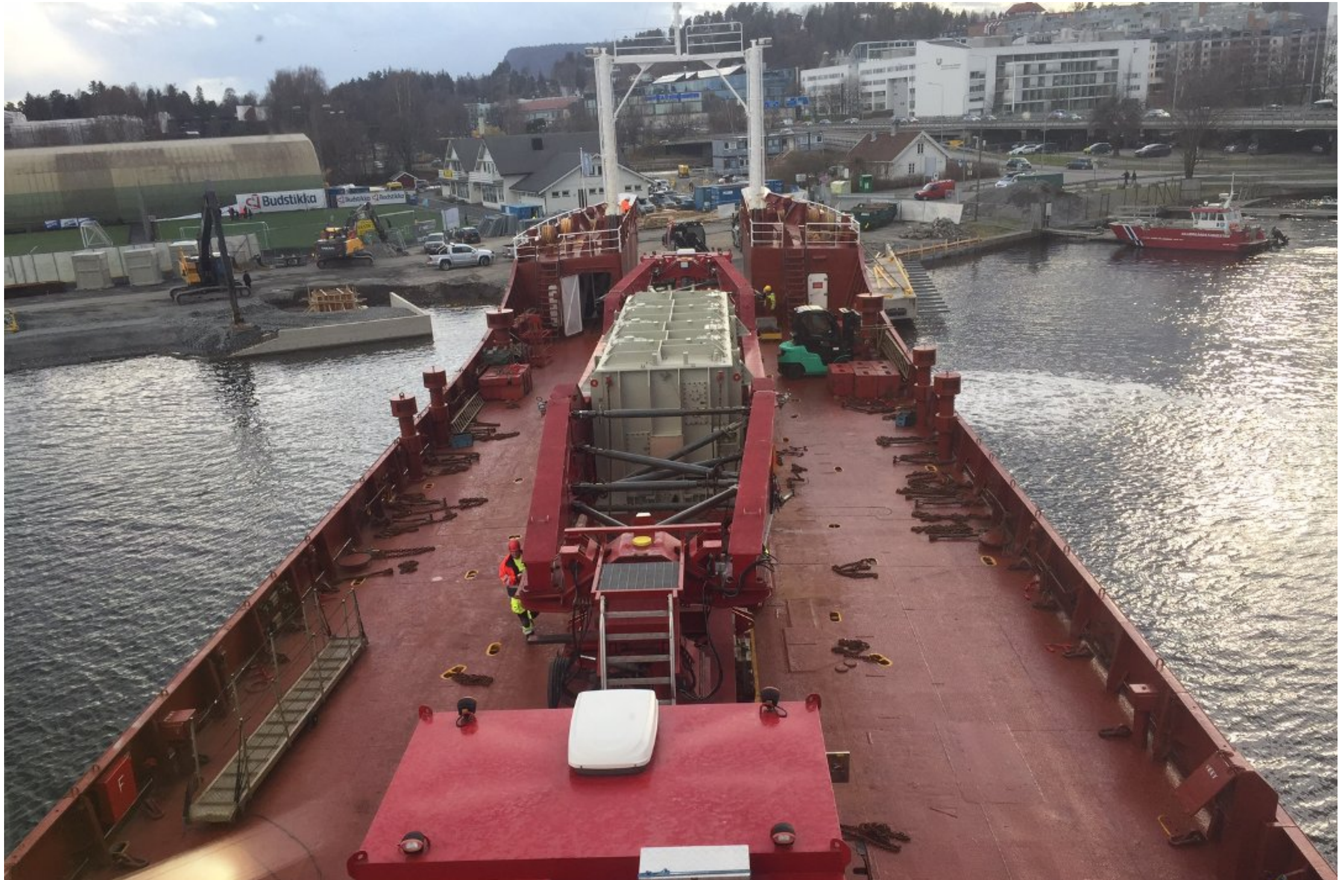
INN TIL KADETTANGEN: Transformatoren på 185 tonn er fraktet på båt fra Nederland til Bærum. Torsdag ved 18-tiden ankom den Sandvika. Neste etappe er på landjorden opp til Hamang. Foto: PER ERIK HAGEN
