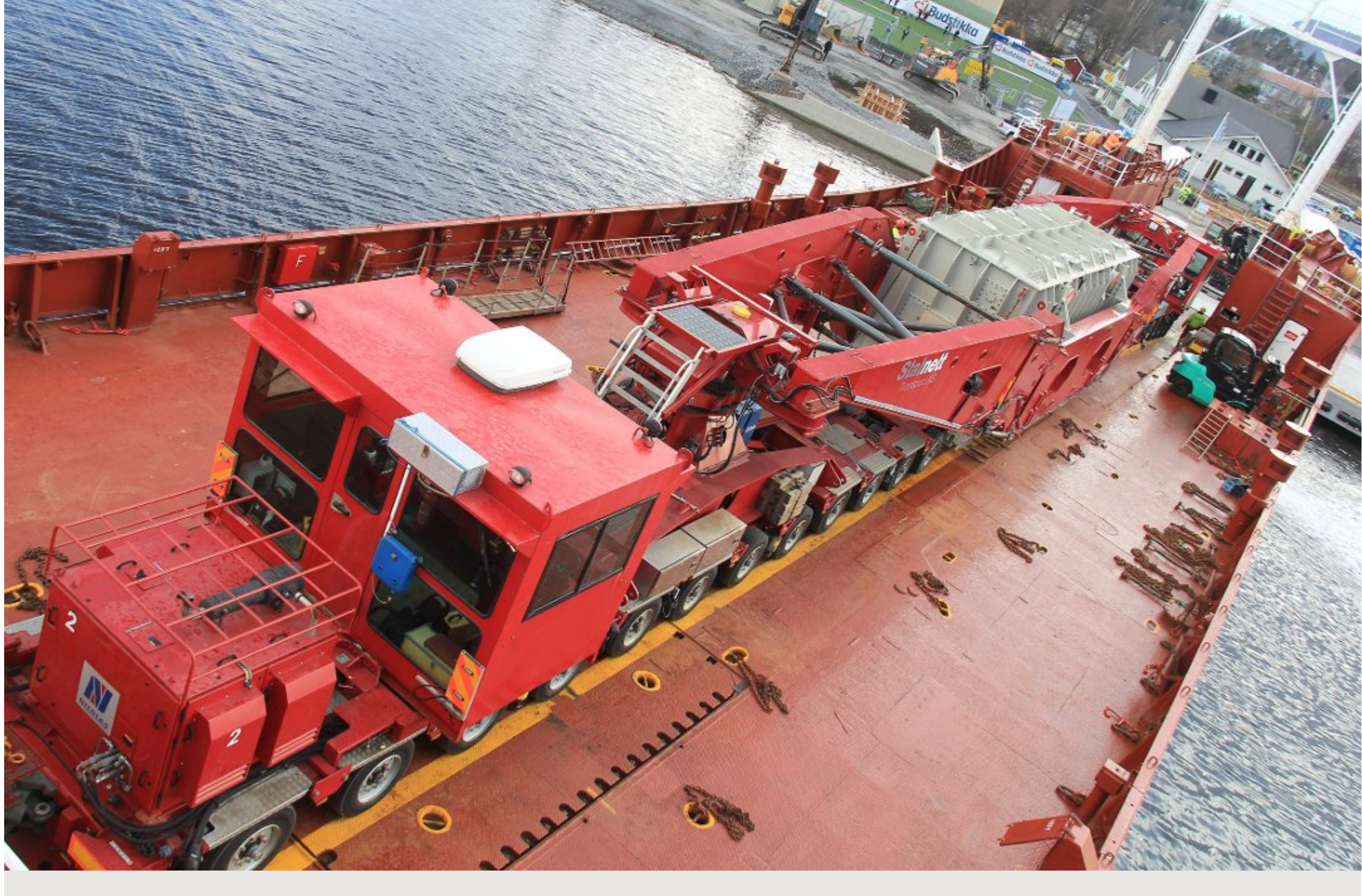
185 TONN: Her er hele spesialvogntoget med transformatoren (grå) oppå. Bildet er tatt fra broen på frakteskipet. Foto: PER ERIK HAGEN
